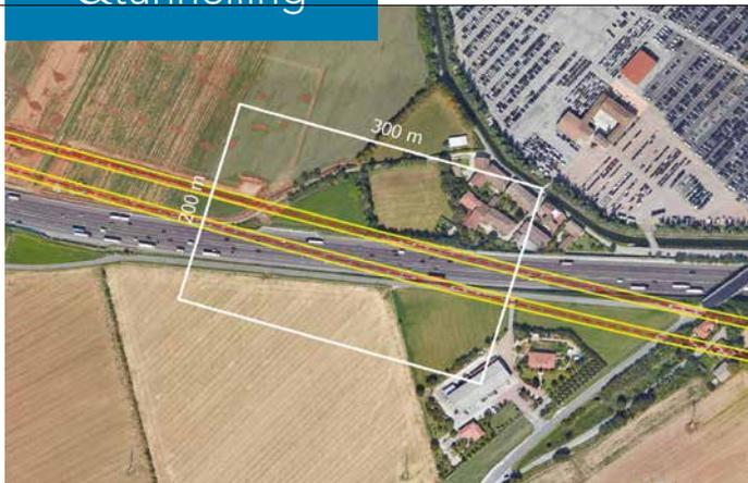
4. La planimetria con ubicazione delle canne della galleria naturale Lonato e dell'Autostrada A4 nel tratto interessato dall'interferenza. Nella figura è riportata anche l'estensione del modello numerico tridimensionale
